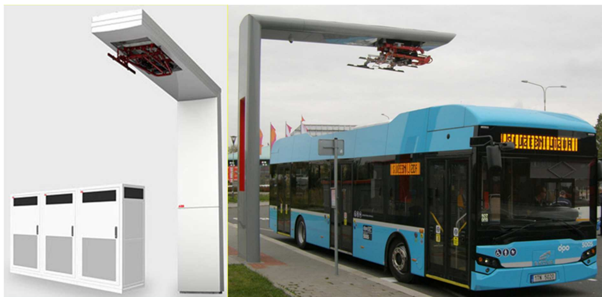
obr. 14 Provedení nabíjecí stanice elektrobusů o výkonu 450 kW od firmy Siemens
