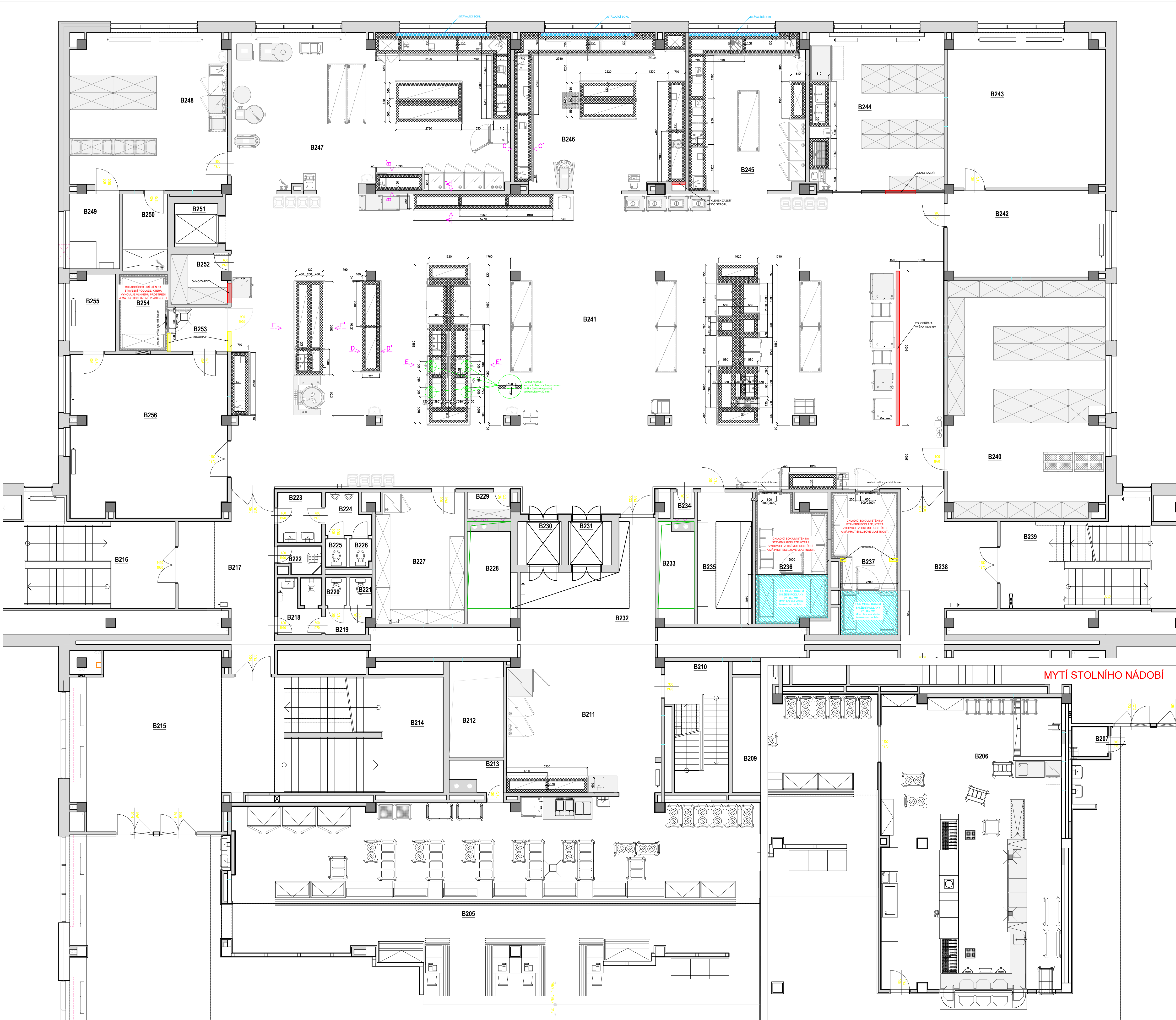
DETAIL UMÍSTĚNÍ STAVEBNÍCH SOKLŮ POD TECHNOLOGIÍ GASTRO - rozměry se rozumí vč. obkladu nebo jiné finální povrchové úpravy a je třeba je dodržet přesně!
